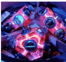
I ring laser gyroscopes commerciali hanno tipicamente forma triangolare, in questo modo si minimizza il numero degli specchi necessari. Qui a fianco vediamo proprio un'unità composta da tre giroscopi laser triangolari della Honeywell.
