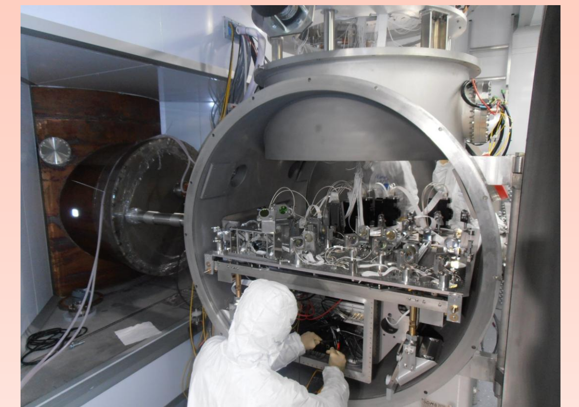
IL BANCO OTTICO in USCITA nella sua CAMERA a VUOTO, qui aperta per un intervento.
